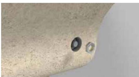
Mettre en place la rondelle et l'écrou délicatement à la main (attendre 24 heures avant de serrer définitivement). Le bout de la tige doit se trouver bien à l'intérieur de la moulure et ne doit pas dépasser.
