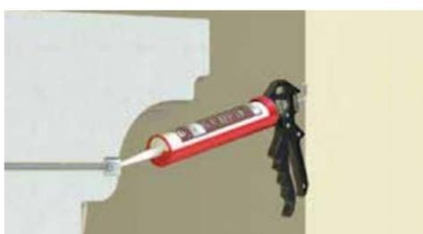
Reboucher avec le mastic DOMOSTYL® LM215 et utiliser le sable fourni avec les modénatures afin de donner une surface homogène au produit. Pour les trous de plus grande dimension, combler avec de la mousse PU, puis réaliser la finition à l'aide de l'enduit fourni.
